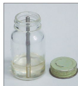
図3. キシレンで希釈した封入剤とアルミ棒
